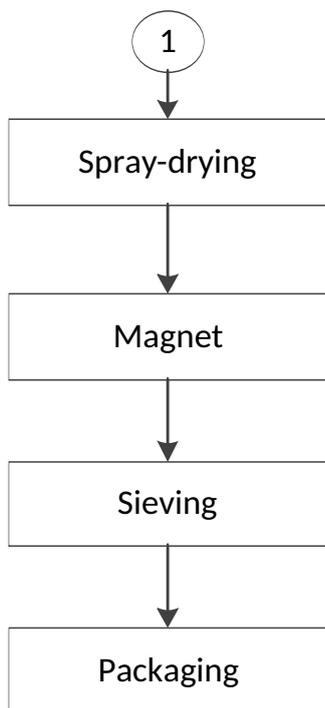
Magnet strength min. 6000 Gauss
